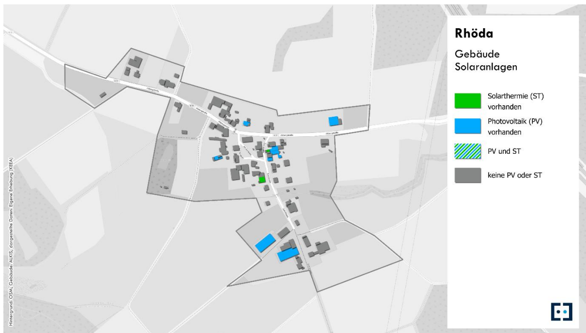
Abbildung 14: Gebäudebestand mit Photovoltaik- und Solarthermie-Anlagen
